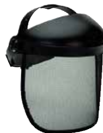
PANTALLA FACIAL 302400425 425, indicada contra impactos de partículas. Malla metálica pintada. Medidas: 200x320mm.
