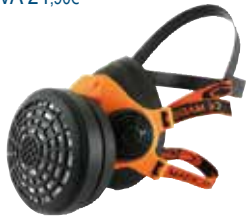
SEMI MÁSCARA 302400761 761. Fabricada en caucho natural. Incorpora un filtro Climax 760 A1 para gases y vapores. Conexión rosca. Normativa EN 140:1998.
