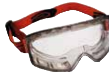
GAFA DE PROTECCIÓN 302400519 AZAHARA. Protección frente a riesgos mecánicos, químicos, polvo, gotas y nieblas de líquidos. Normativa: EN 166: 2001. EN 172: 1994/A1: 2000/A2: 2001 EN 170: 2002.
