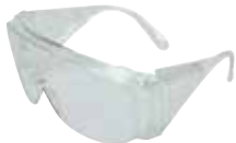
GAFA DE PROTECCIÓN 302400580 580/2T. Ocular de tipo panorámico en policarbonato incoloro. No posee acción filtrante ni efectos correctivos. Espesor nominal 2,5 mm. 142 mm x 57 mm.
