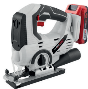
CALADORA BATERÍA 210080010 WORGRIP. 20V. Velocidad 0 - 2400 RPM. 230 V ~ 50 Hz (cargador). Base ajustable en 0-47°. Batería de Litio de 2000 mAh. Tiempo de carga 60 minutos. Boquilla de extracción trasera. Adecuada para plástico, metal y madera.
