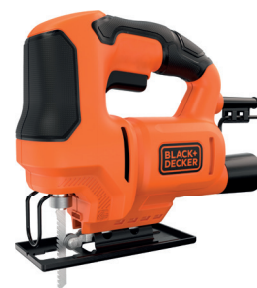
SIERRA CALAR B&D 201200602 400w, velocidad 3.000 cpm, corte a bisel 0 - 45°, longitud de carrera 18mm. incluye 1 hoja de corte para madera.
