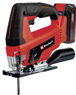
CALADORA BATERÍA EINHELL 206520200 Tiempo de carga 50min Alimentación eléctrica del cargador de baterías 200-250 V. 450-60Hz Velocidad sin carga (velocidad de ralentí) 2700 min. Altura de carrera 20 mm Profundidad de corte en madera d de corte en acero 8 mm Máx. cortes en bisel 45°
